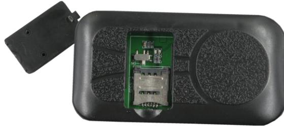
**4.2、安装 SIM 卡（本机使用中 SIM 卡 Micro 卡）：**设备需要插入一张 2G/3G/4G 电话卡，（需要开通 5 元包 30M 数据流量套餐，一般设备每月消耗 20-30M 数据流量，也可以选用纯数据流量卡（无语音无短信），可上网查询，但不能发短信和打电话定位报警）。
