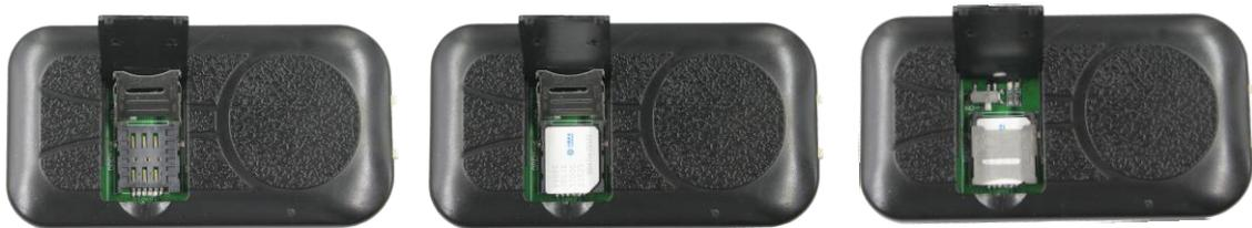
直接用手指把 SIM 卡仓盖子从凹位处向上扣开即可看到 SIM 卡固定座，用手指把 SIM 卡固定座的金属盖如图向上滑即可把金属固定盖掀起，SIM 卡金属接触面面向电路板放置，再把金属固定盖压紧 SIM 卡并向下滑动锁紧即可。
