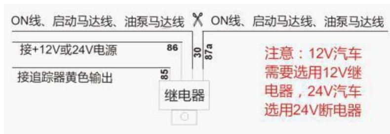
**警告：断油断电会使行驶中的汽车转向和刹车失去助力，从而有引发交通事故和人员伤亡的风险，请慎用此功能，推荐把断路器接在启动马达上，这样使汽车不能发动而不是熄火。**
