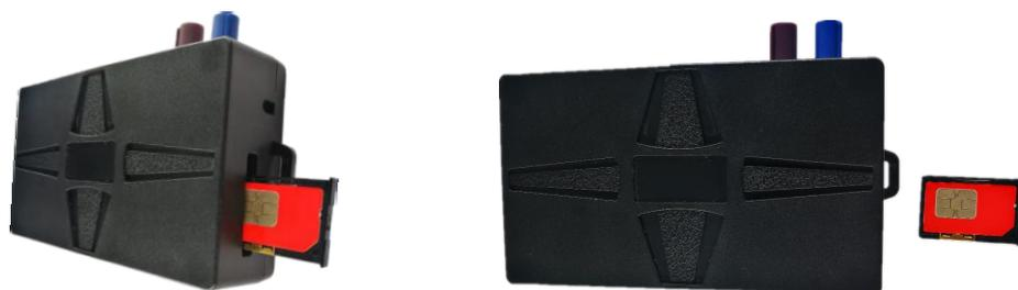
在主机盒侧面有个 SIM 卡槽, 用螺丝刀把黄色的小柱子往里面压, SIM 托槽会弹出来, 用手指把 SIM 卡槽拉出, 如上图所示把 SIM 卡按所示方向放入 SIM 卡槽, 然后把 SIM 卡槽推入 SIM 卡座中即可。
