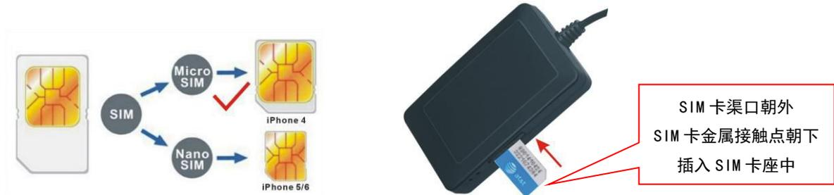
如上图所示，从 CCTR-805 侧面把 SIM 卡仓拨开，即可露出 SIM 卡固定座，SIM 卡缺口朝外金属接触点朝下，把 SIM 卡推入定位器中，可以听到一声咔哒声，SIM 即可锁定在固定座中，如果 SIM 卡方向或接触面不对，则无法找到手机信号，拔出换个面和方向再试一下，SIM 卡被锁定在卡座后把 SIM 卡盖盖住即可。
