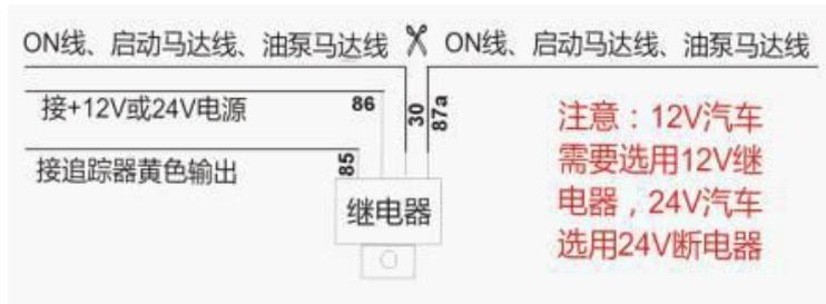
**警告：**断油断电会使行驶中的汽车转向和刹车失去助力，从而有引发交通事故和人员伤害的风险，请慎用此功能，推荐把断电器接在启动马达上，这样使汽车不能发动而不是熄火。
