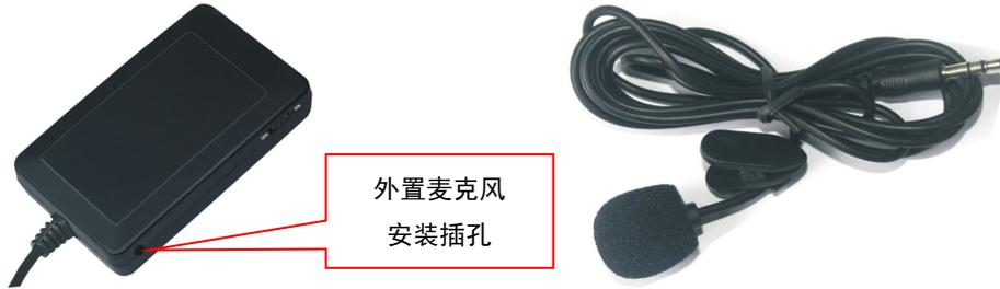
外置监听麦克风直接插入主机出线口旁的专用麦克风插座上，然后把麦克风固定在离驾驶员较近的隐蔽的地方，以便能听到清晰的声音。
