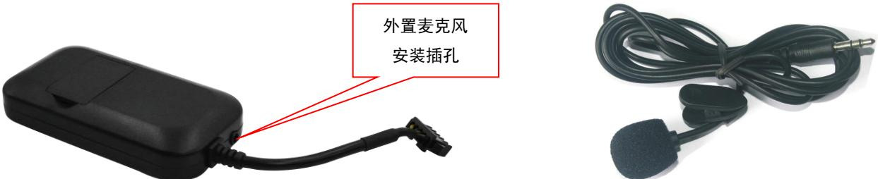
外置监听麦克风直接插入主机出线口旁的专用麦克风插座上，然后把麦克风固定在离驾驶员较近的隐蔽的地方，以便能听到清晰的声音。
